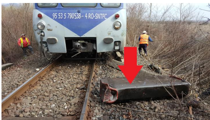
Imaginea 6 - rezervorul căzut de la vagonul remorcă LVS 538
