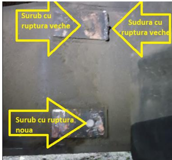
Imaginea 7 – zona de prindere a rezervorului pe șasiul vagonului remorcă LVS 538
