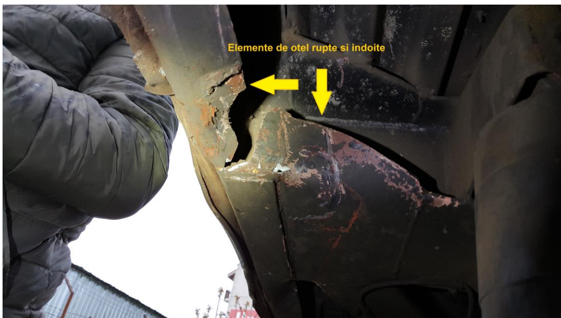
Imaginea 9 – deformări mecanice a elementelor de șasiu, provocate de un corp solid care a exercitat o forță de jos în sus asupra șasiului
