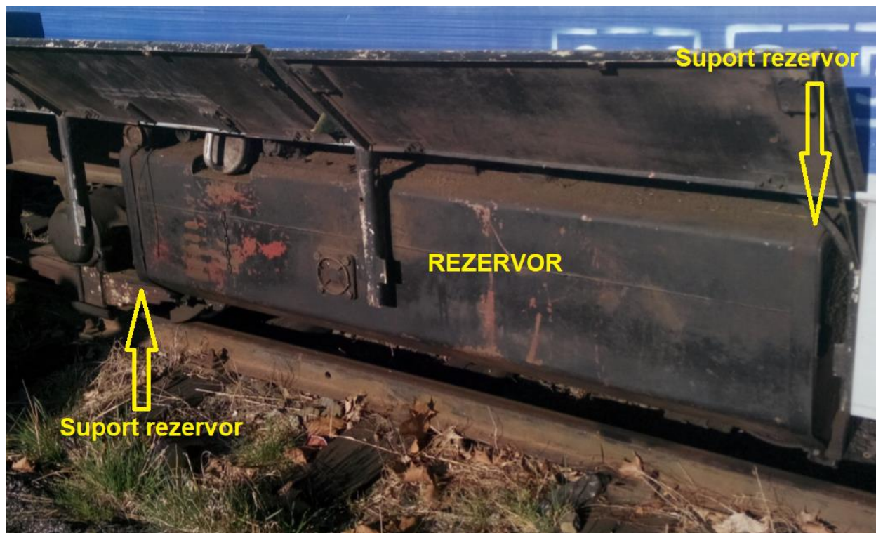
Imaginea 3 - rezervorul pentru motorina de încălzire și suporturile acestuia.
