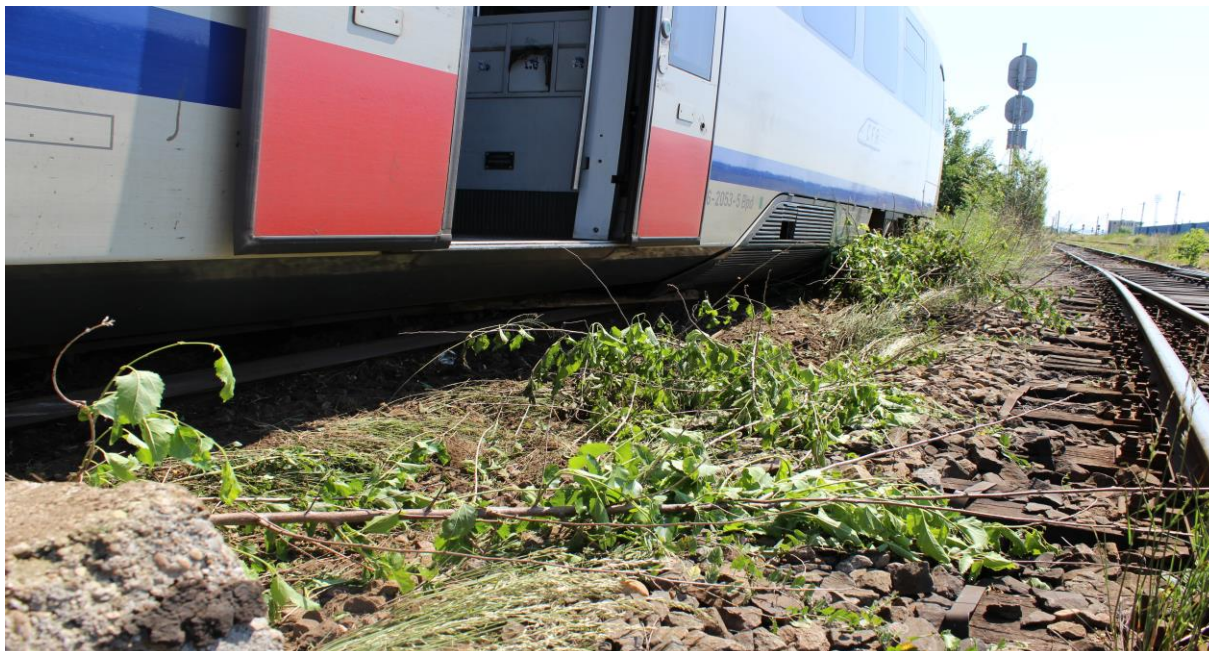
Foto 1. Poziția automotorului Desiro 2053 după deraiere
