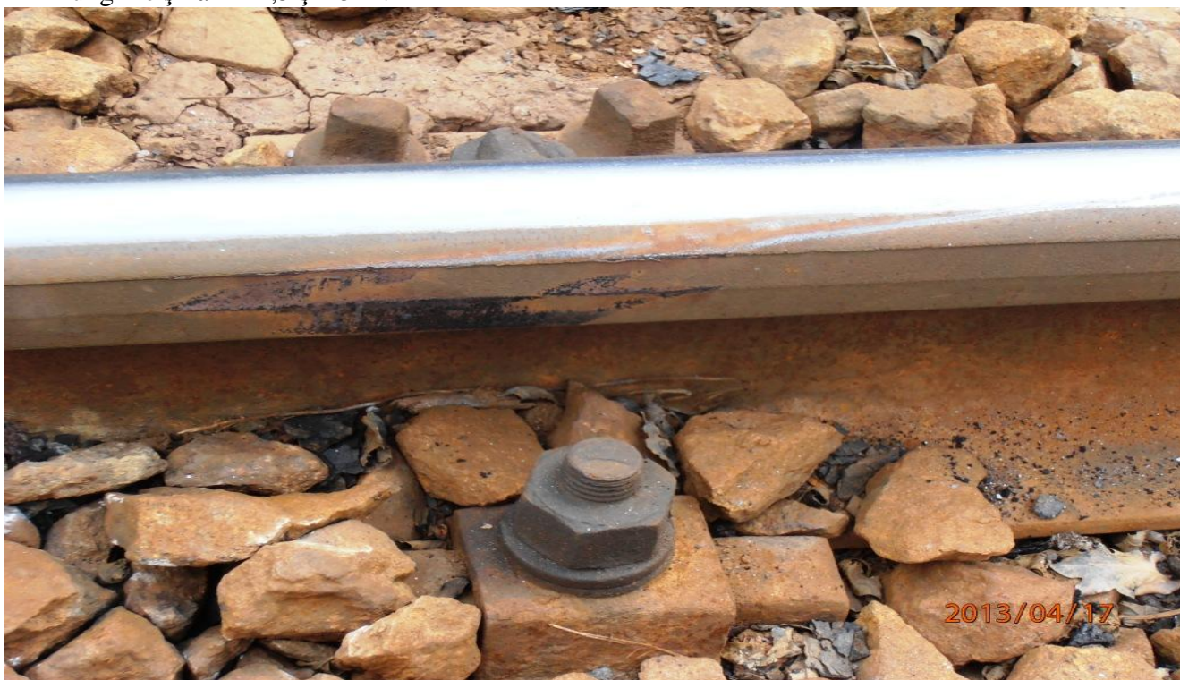
Foto 1. Locul escaladării şinei de către roata din stânga a primei osii de la vagon
