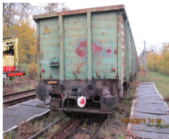
Fig. nr.2: Urmările coliziunii dintre DP58 și vagonul de marfă
