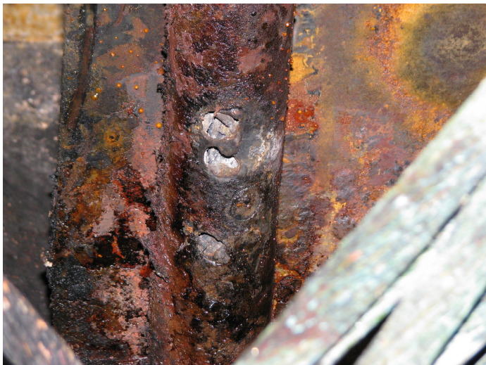
Imaginea 4 – țeava de protecție din oțel găurită din cauza scurtcircuitului electric;
