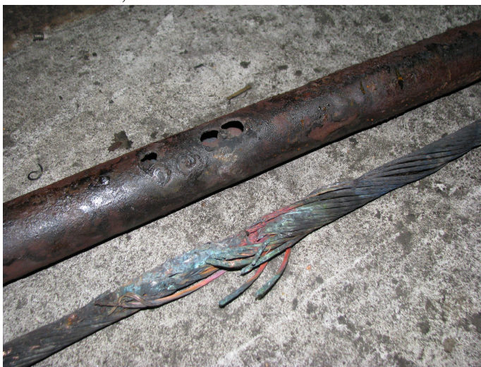
Imaginea 5 – țeava de protecție din oțel găurită și cablul electric topit;
