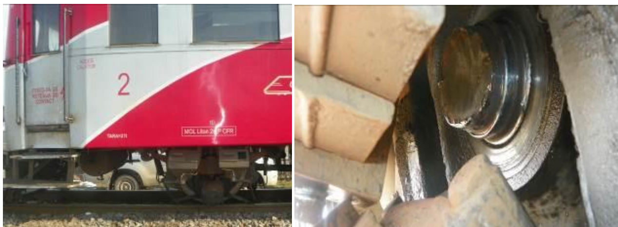
Foto nr.1 – ruperea fusului de osie din partea stângă în sensul de mers respectiv din partea scurtă a osiei motoare
