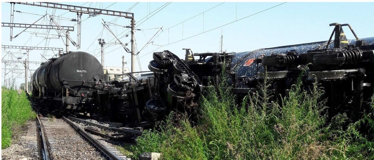
Foto nr.1 – poziționarea vagoanelor răsturnate
