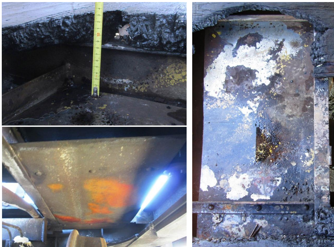
Foto nr.3, tabla parascânteii aferentă roții nr.4 (vedere de jos, de sus și distanța față de podeaua vagonului)
