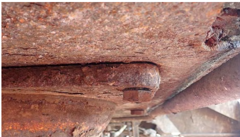
Imaginea nr. 19 - traversa crapodinei superioare deformată (înfundată)
