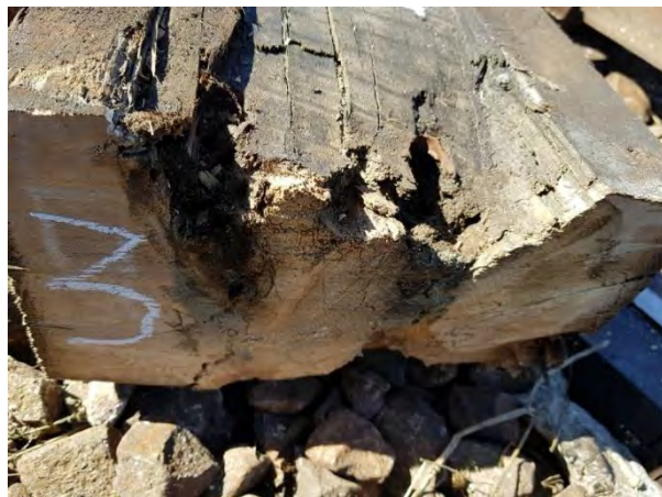
secțiunea nr.2 - inimă roșie, crăpături pe fața superioară și crăpătură în adâncime pe lungimea chitucului, lemn putrezit pe fața superioară și în interior
