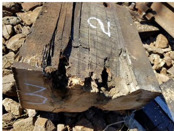
secțiunea nr.2 - inimă roșie, crăpături pe fața superioară și crăpătură în adâncime pe lungimea chitucului, lemn putrezit pe fața superioară și în interior
