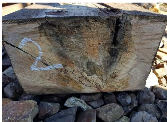
secțiunea nr.2 - inimă roșie, crăpături dinspre fața superioară spre interior, formare secțiuni de rupere
