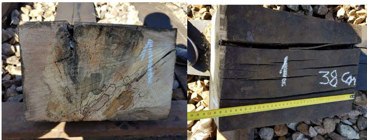
secțiunea nr.1 - inimă roșie, crăpături dinspre fața superioară spre interior, formare secțiuni de rupere
