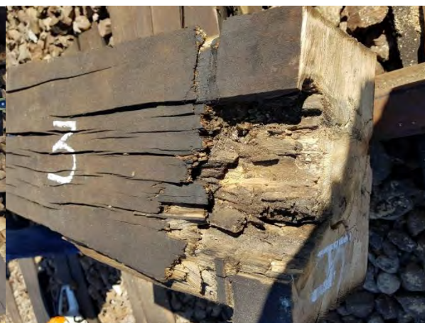
secțiunea nr.3 - crăpături pe fața superioară și crăpătură în adâncime pe lungimea chitucului, lemn putrezit pe fața superioară și în interior
