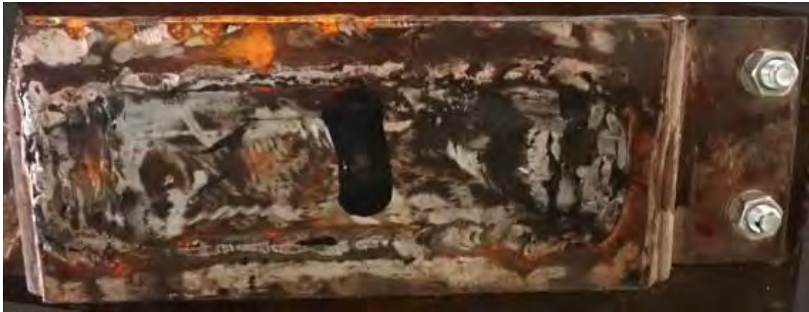
Foto nr.12 - Piatră de frecare superioară, recondiționată
