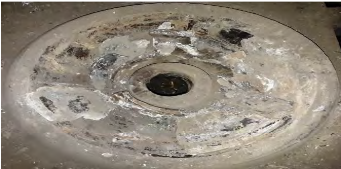
foto 23: crapodina inferioară boghiu II vagon nr.81536654073
