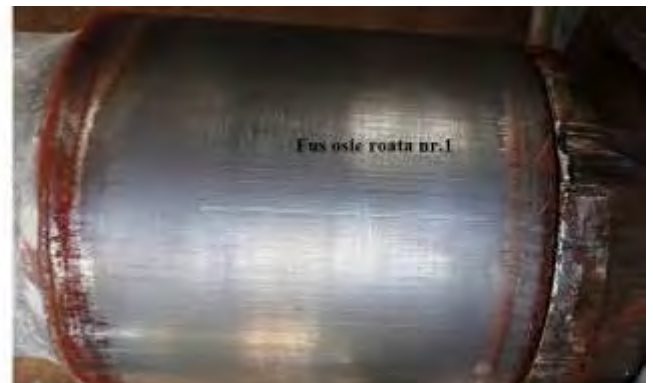
Foto nr.11 – Fusurile osiei cu roțile 1-2 după depresare
