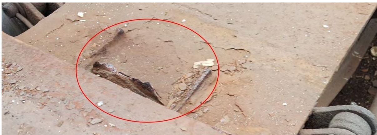
Foto nr.17 piatra de frecare inferioară lipsă, de la primul boghiu partea cu roțile 1-3
