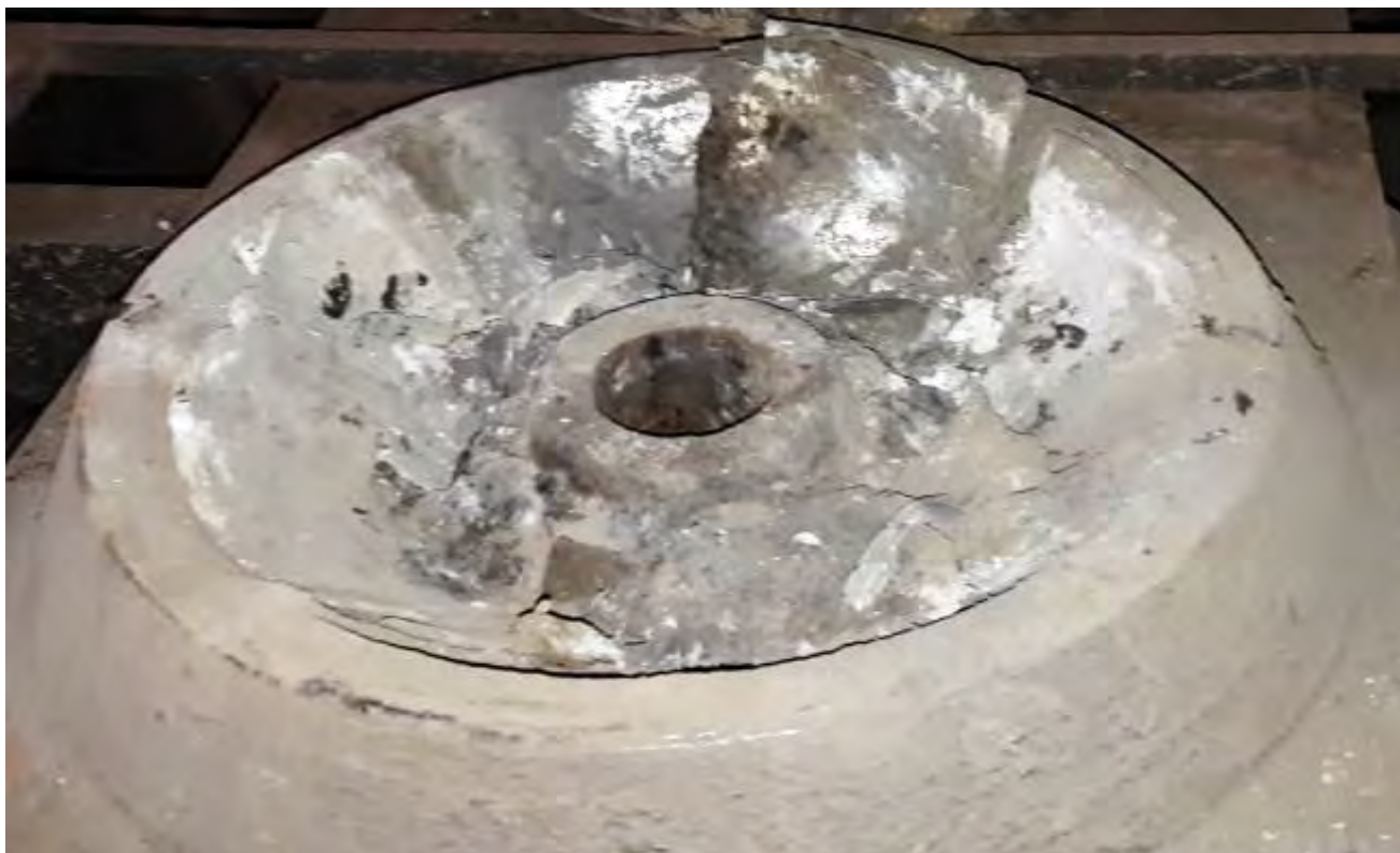
foto 25: crapodina inferioară boghiu II vagon nr. 81536652301-8
