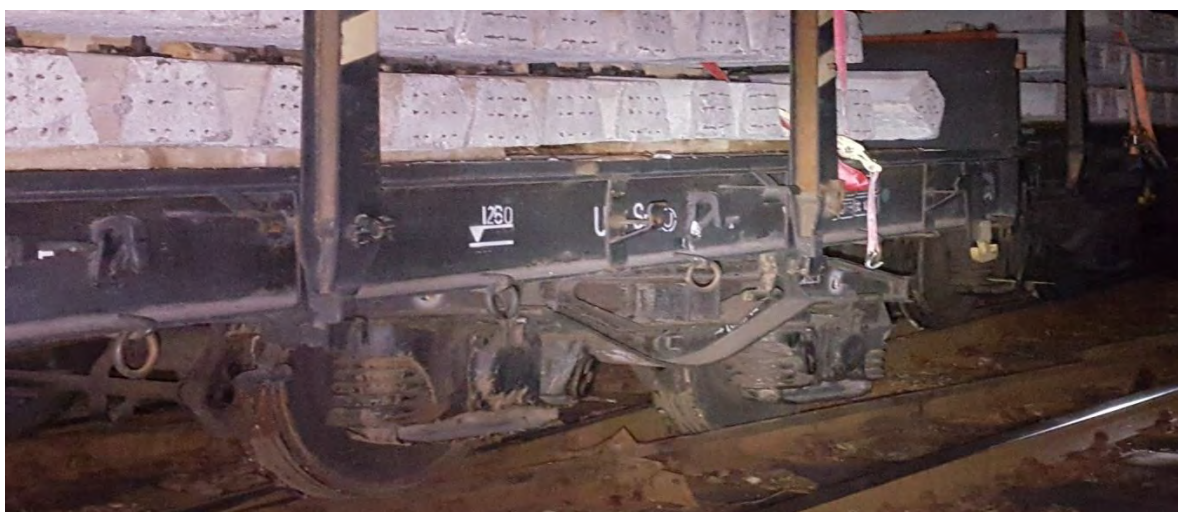
Foto nr. 1 – poziția roților deraiate
