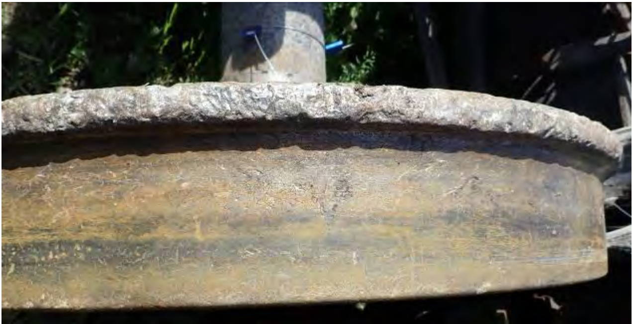
Foto nr.10 – Aspectul suprafeței de rulare și buzei bandajului ca urmare a circulației în stare deraiată
