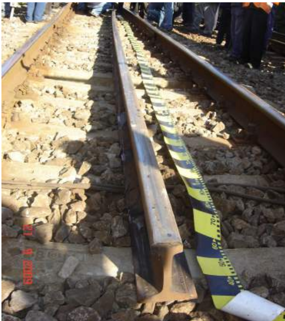
șină deformată ca urmare a forțelor laterale de împingere foto 5 provenite de la materialul rulant deraiat
