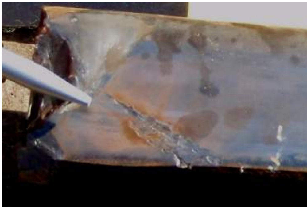
materialul metalic desprins din ciuperca șinei și urma foto 9 de rulare a buzei bandajului roții
