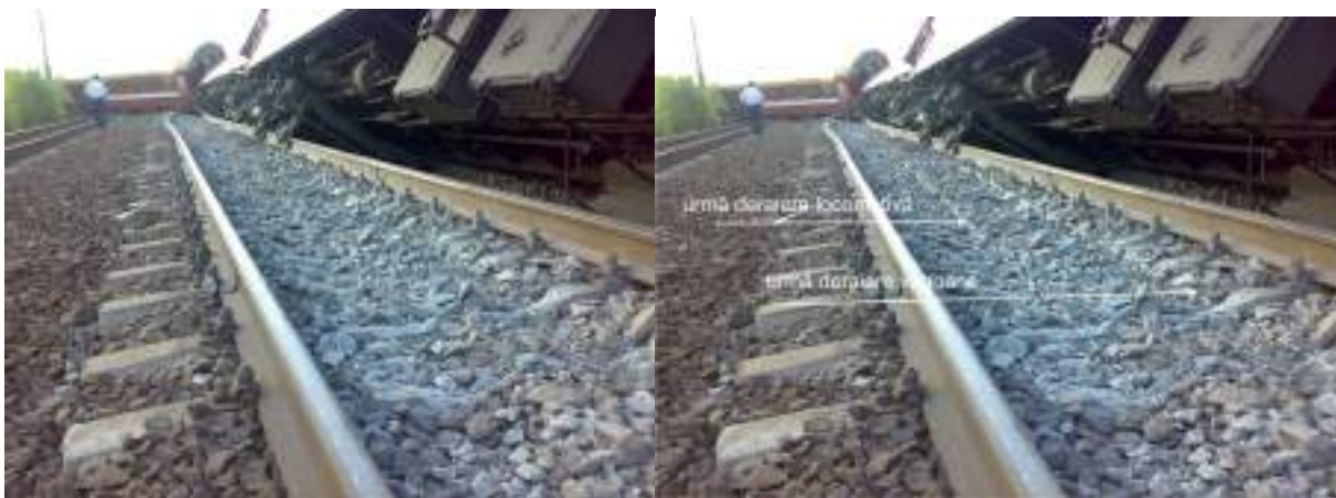
urmele lăstate de locomotivă buzele bandajelor roților din partea stângă ale locomotivei foto 16
