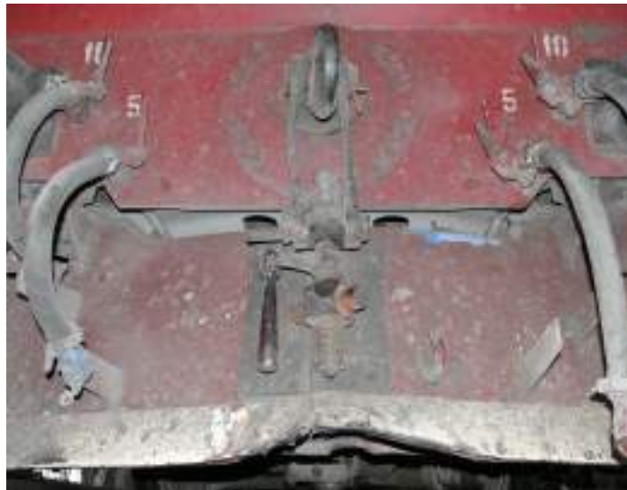
apărătorul de animale deformat foto 15
