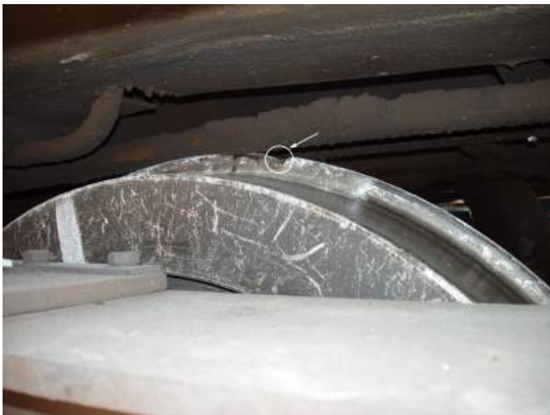
vagonul al 4 - lea primaosie boghiul al 2-lea urma de lovire a șinei din partea dreaptă foto 28
