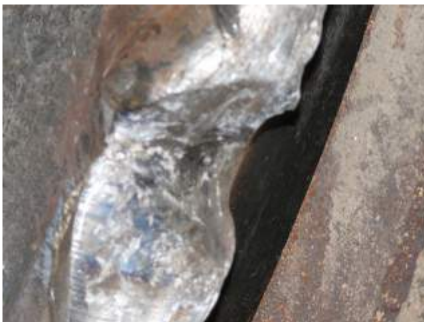
vagonul al 5-lea de la locomotivă - deformarea buzei bandajului roții foto23 din partea dreaptă a osiei nr.1 a boghiului nr.1 în sensul de mers
