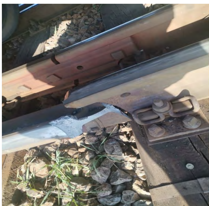
Foto nr.15 – sudura ruptă dintre șina de legătură și contraacul drept al schimbătorului de cale nr.1
