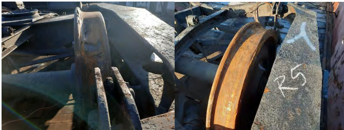
Foto nr.5 - urme foarte pronunțate de mers frânat necomandat, locuri plane cu lungimi și adâncimi mari la al doilea boghiu în sensul de mers
