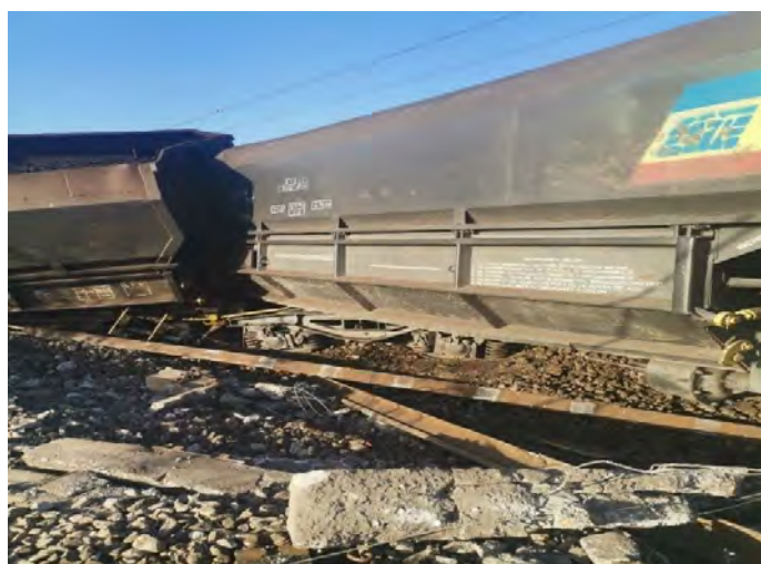
Foto nr.16 – șine rupte și torsionate și traverse din beton distruse
