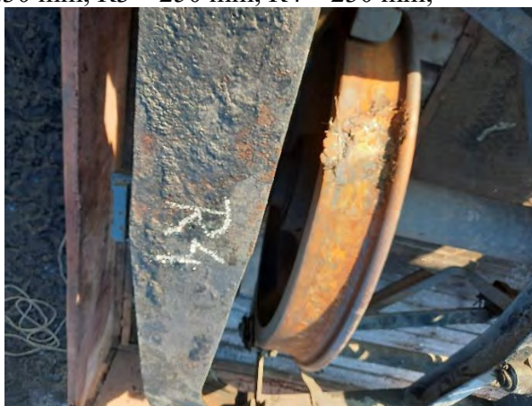
Foto nr.4 - locuri plane cu depuneri de material la primul boghiu în sensul de mers
