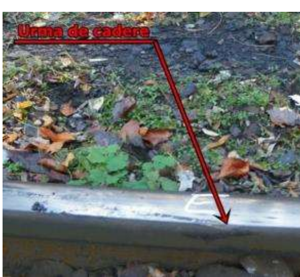
Foto nr.6: Punctul „E” – urmă de cădere în interiorul căii (roata din partea stângă a osiei nr.5)
