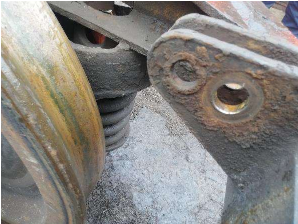
Imaginea nr.7 – Locul de unde a căzut atârănătorul portsabot
