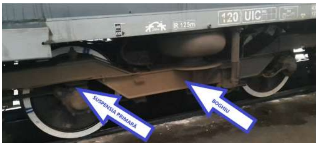
Imaginea nr.5 – localizarea arcurilor metalastic (suspensia primară)
