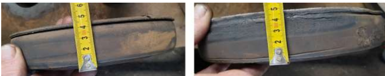
Imaginea nr.7 – arc metalastic deformat cu înălțimea cea mai mică de 44 mm și cea mai mare de 50 mm.
