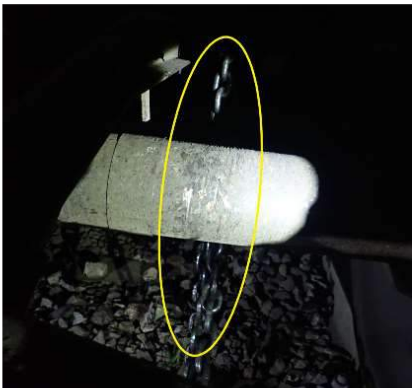
Foto nr.9 – urme de frecare pe osie/bucata de lanț căzută
