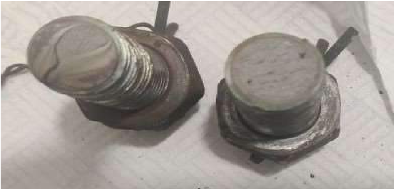
Foto nr.6 Filete șuruburi forfecate
