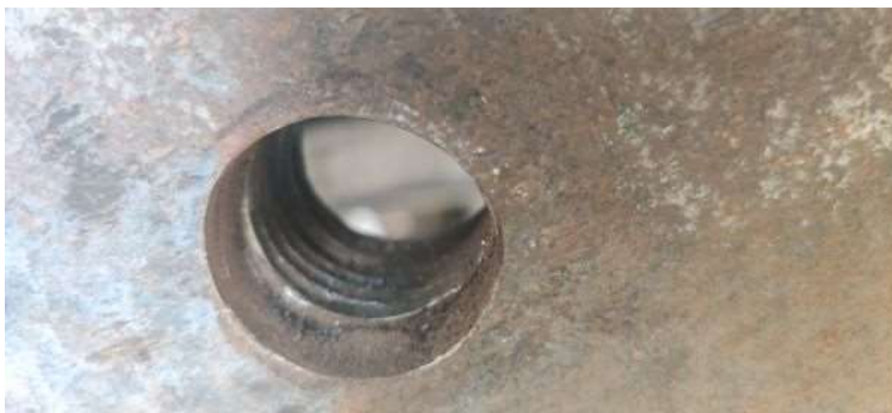
Foto nr.7 Urmă pronunțată de imprimare a filetului la gaura din partea dreapta de jos pe traversa frontală
