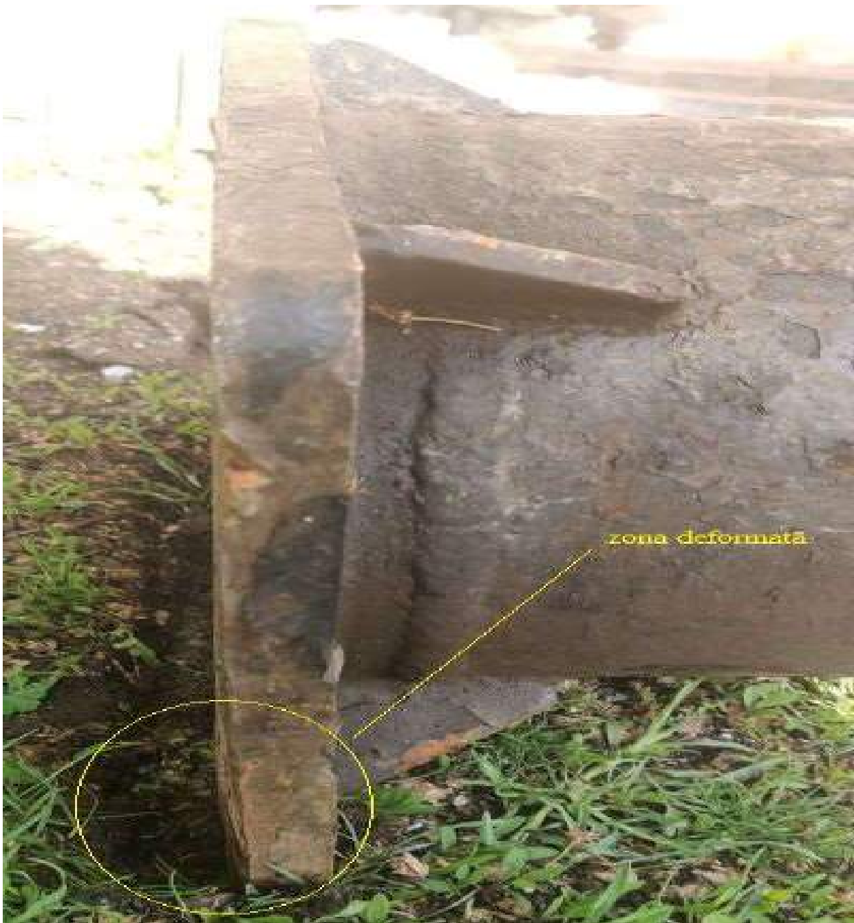
Foto nr.4 Deformație la partea inferioară talpă aparat ciocnire
