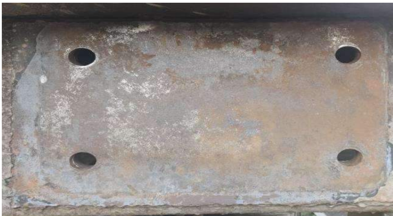
Foto nr.6 Găurile de prindere a aparatului de ciocnire de pe traversa frontală a vagonului
