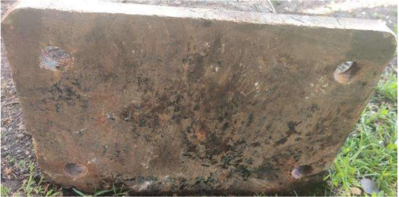
Foto nr.3 Talpa de fixare a aparatului de ciocnire (vizibil aspectul găurilor de fixare)
