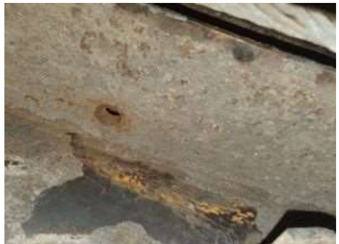
Foto nr.7: Găurile de prindere a pietrei de frecare pe cadrul boghiului
