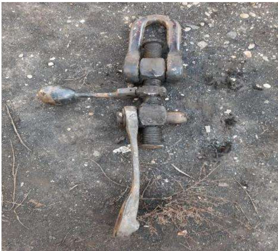
Foto nr.4: parte din cuplă găsită pe teren, lângă primele două vagoane deraiate
