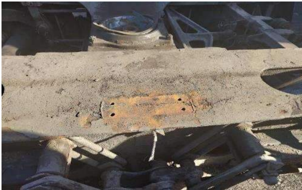
Foto nr.6: Locul pietrei de frecare de pe cadrul boghiului cu roțile nr.5-8
