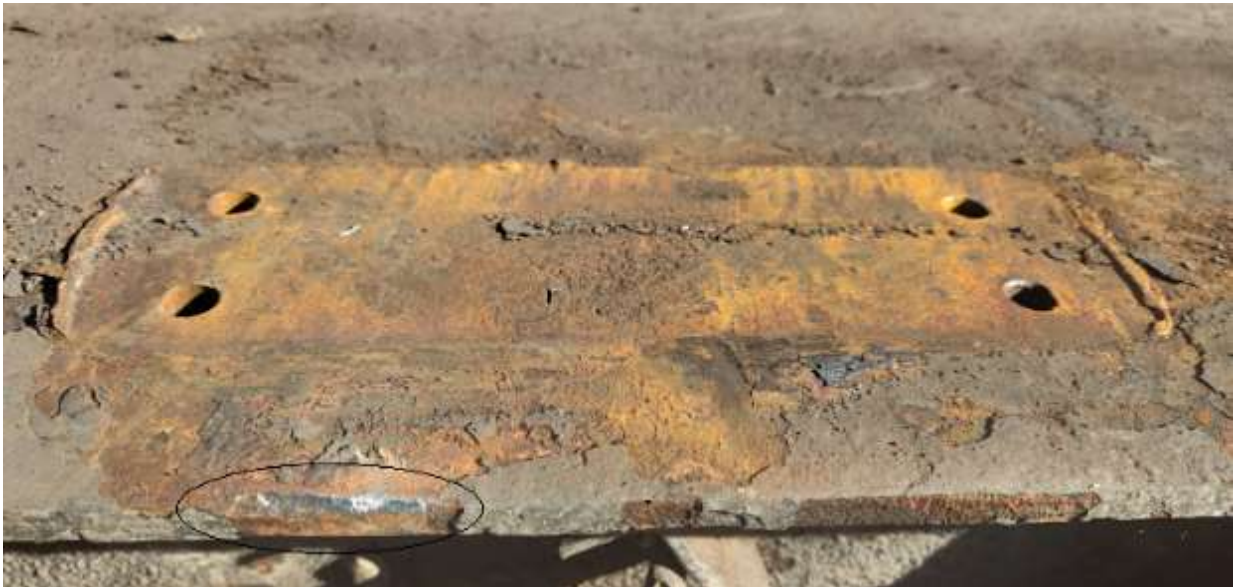
Foto nr.8: Urmă de lovitură recentă pe cadrul boghiului în dreptul pietrei de frecare
