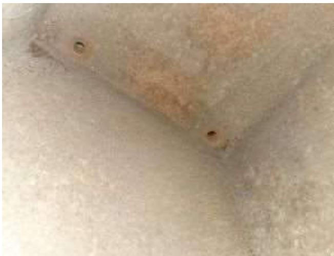
Foto nr.7: Găurile de prindere a pietrei de frecare pe cadrul boghiului
