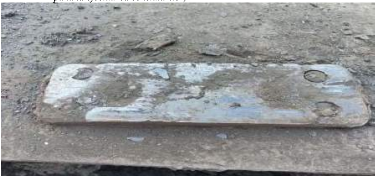
Foto nr.10: Piatră de frecare prezentă pe partea stângă a cadrului boghiului cu roțile nr.5-8
