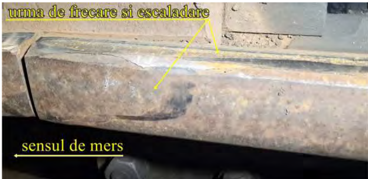
Foto. nr.18 – urma de escaladare a flancului inactiv al acului drept
