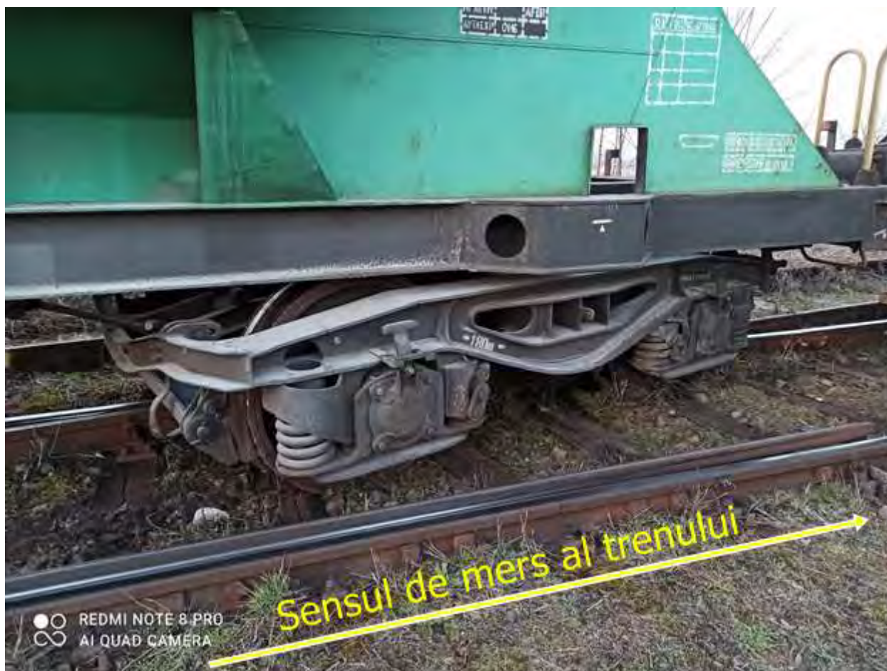
Foto nr.1 Vedere laterală al primului boghiu (deraiat) al vagonului nr.33539335900-5
