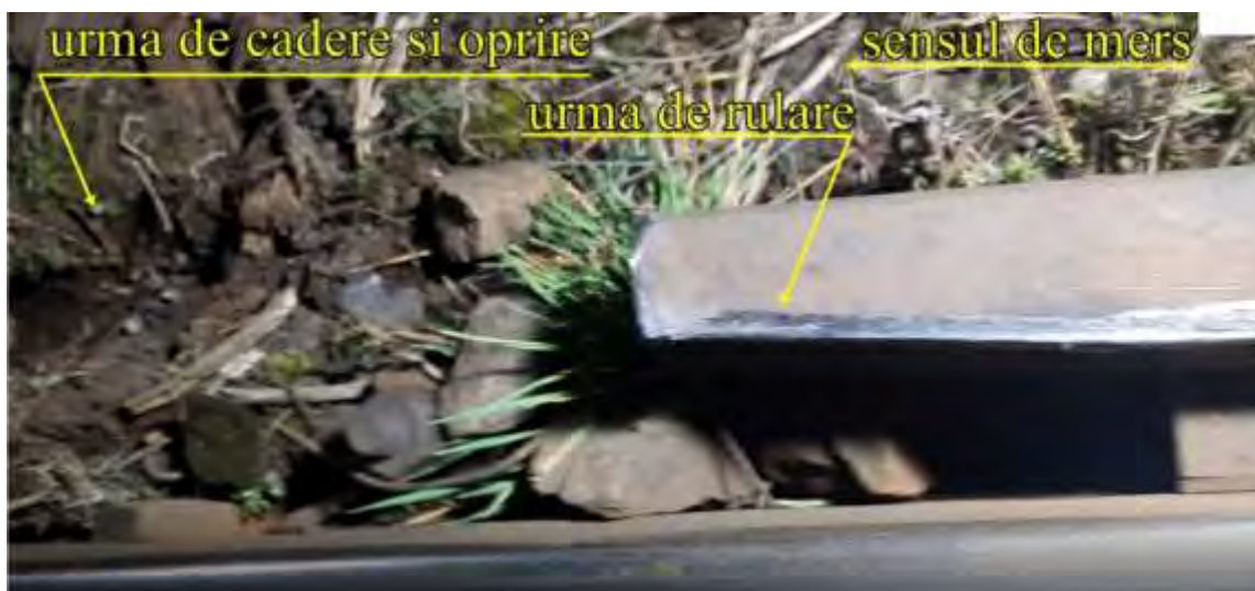
Foto. nr.23– urma de rulare, urma de cădere de pe șina cot a inimii simple a schimbătorului nr.21 și urma de oprire
