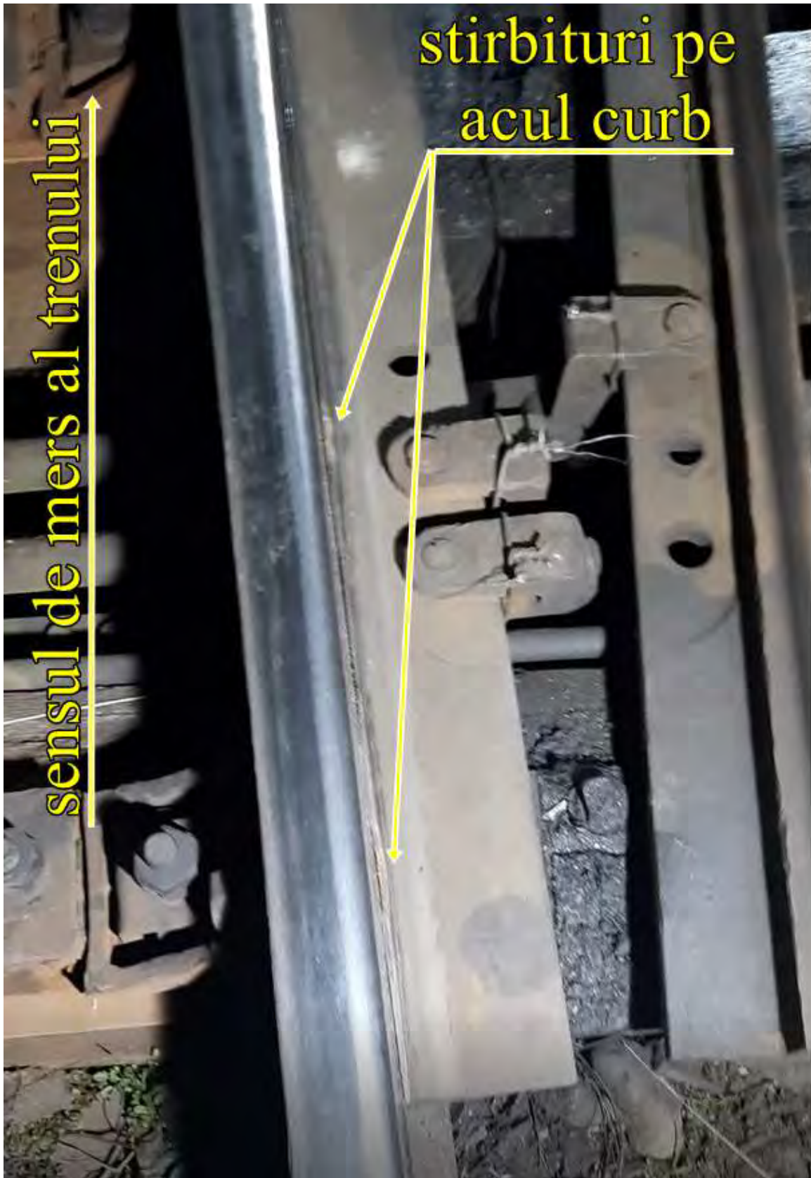
Foto. nr.9 – știrbituri pe prima parte a acului curb
