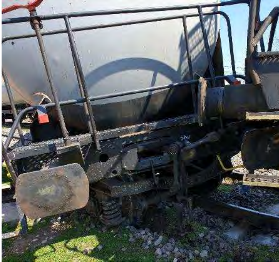
Foto nr.6 - Al doilea boghiu care a mers în stare deraiată pe „directă” (firul I de circulație) până la km 1+550
