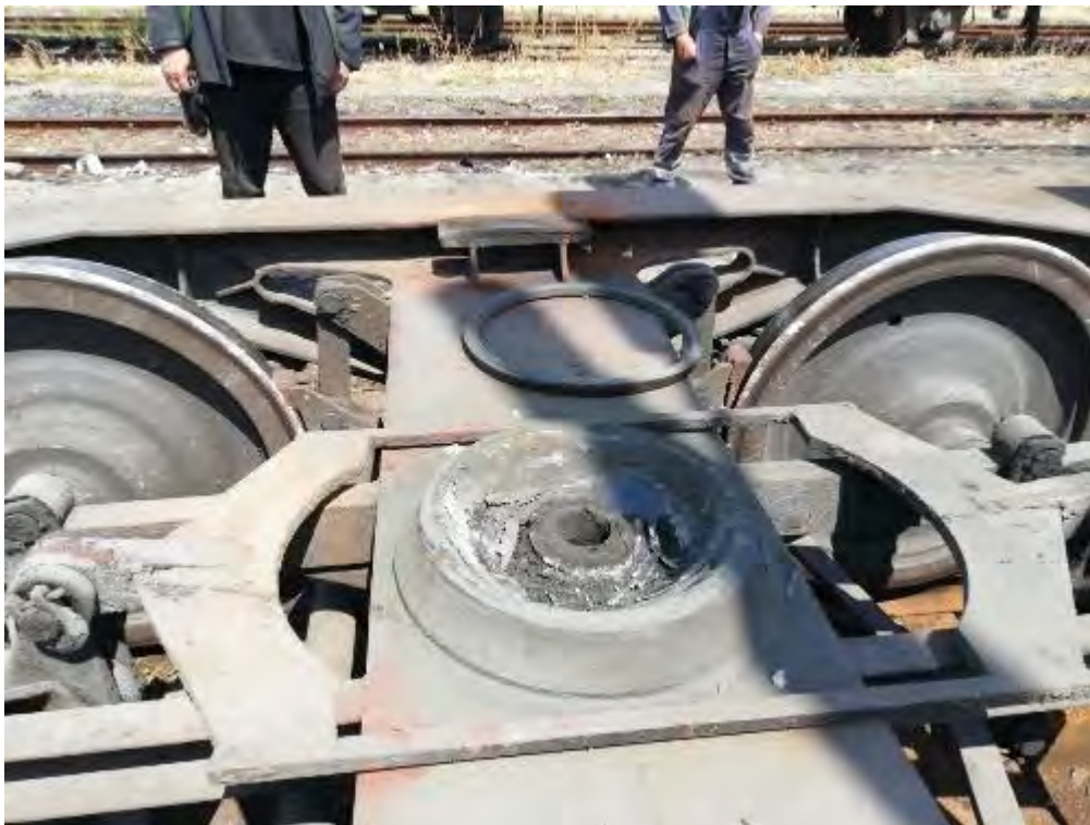
Foto nr.6: vagonul nr. 82536993757-8, crapodina inferioară boghiul cu roțile nr.1-4
