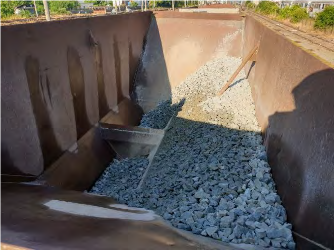
Foto nr.3: starea celor 4 compartimente ale vagonului la momentul producerii deraierii
