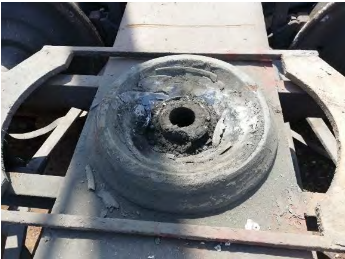
Foto nr.4: vagonul nr. 82536993757-8, crapodina inferioară boghiul cu roțile nr.5-8
