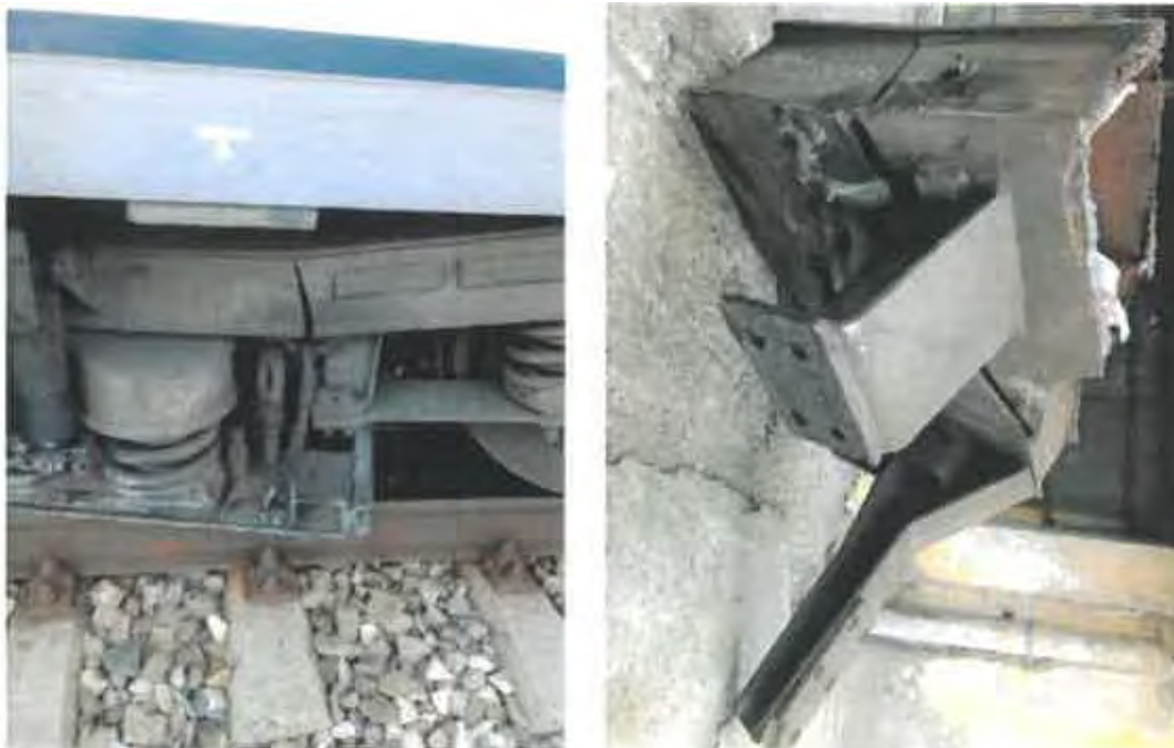
Foto nr. 3. -Aspect vizual cu rupere la încovoiere a plăcii inferioare de susținere și a lonjeronului
