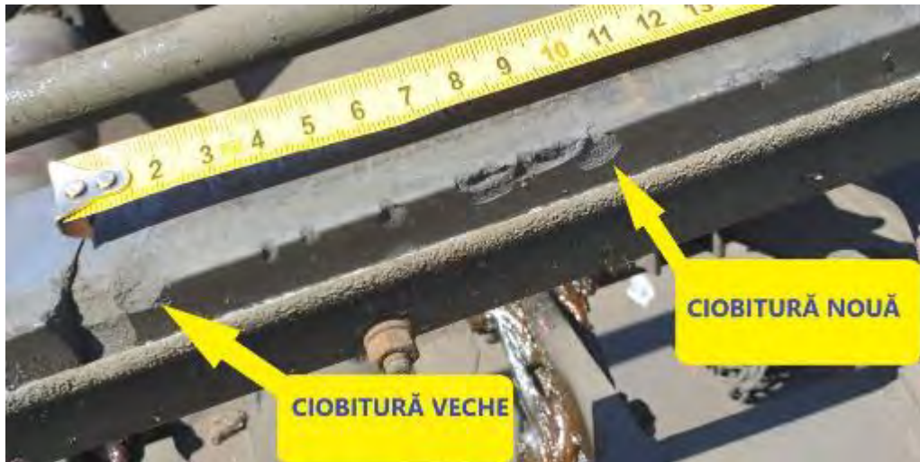
Imaginea 7 - Exemple de ciobituri vechi și noi, la peria de cărbune
