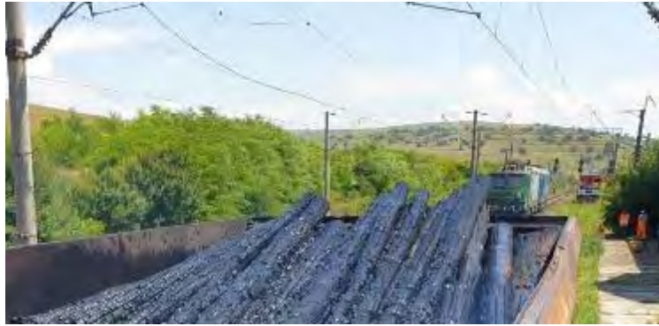
Imaginea 12 – buștenii erau mai afectați de ardere în capătul spre locomotivă.
