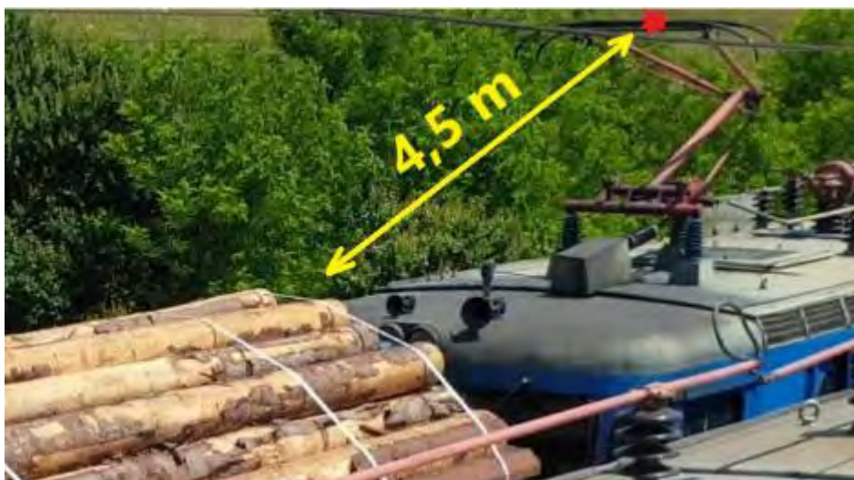
Imaginea 18 – poziția zonei de contact perie/LC față de buștenii încărcăți (reconstituire)
