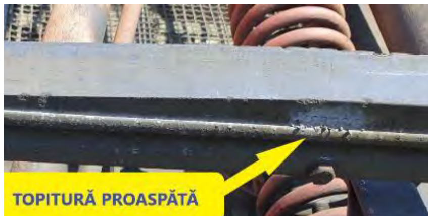
Imaginea 8 – granule de aluminiu topit proaspăt la sania patinei, cu urme de fum proaspete pe perie Zonele de aluminiu topit erau concentrate pe șina de aluminiu, în zona șuruburilor de strângere
