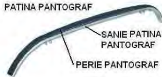
Imaginea 5 – patina de pantograf, sania patinei și peria pantografului
