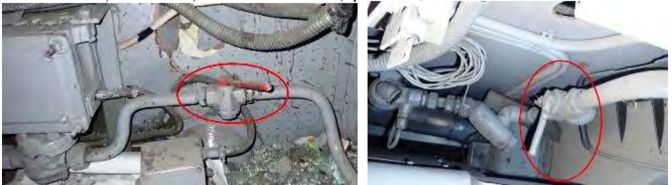
Foto nr.4 - robinetii de izolare pneumatică a instalațiilor DSV și INDUSI de la locomotiva EA 194
