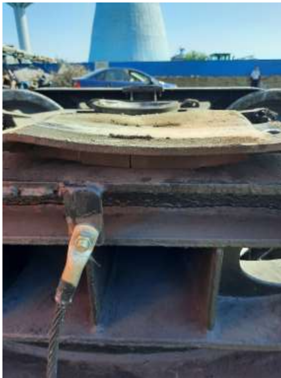
Foto nr.1 - piatra de frecare superioară, aferentă roților 5-7, demontată, puternic deformată ca urmare a rulării vagonul în stare deraiată
