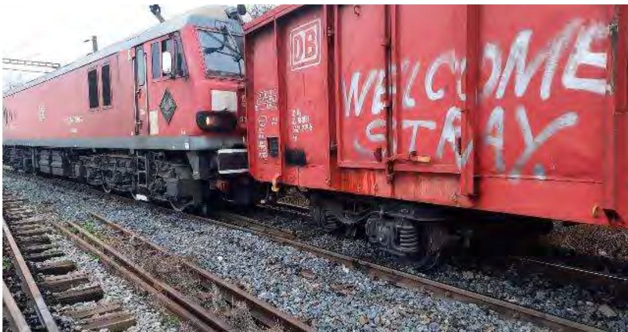
Foto nr.1: vagonul nr.33535421218-5. în stare deraiată
