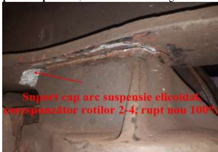
Foto nr.2 - suport cap arc suspensie elicoidal, corespunzător roților 2-4, rupt 100%
