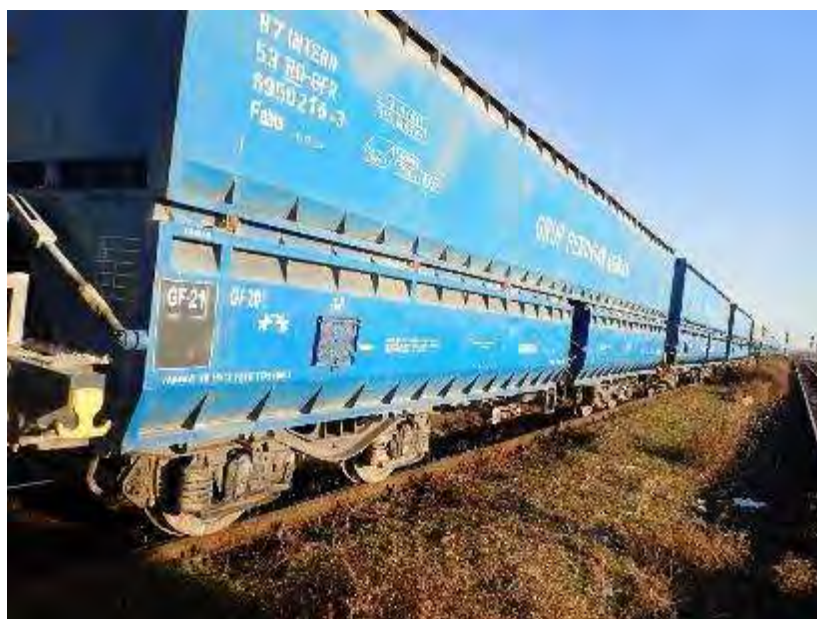
Foto nr.5 - vagoanele deraiate pe o lungime de 130 m
