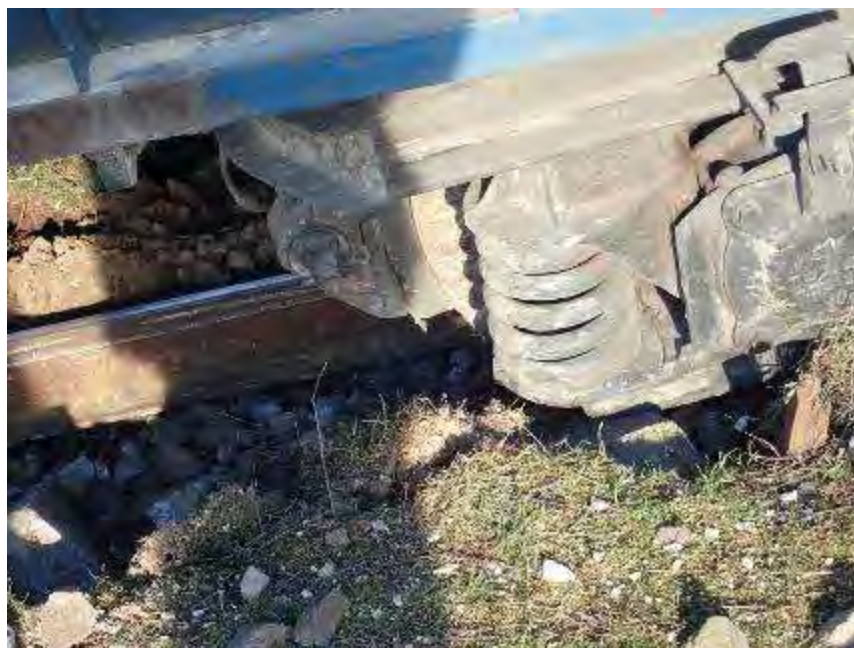
Foto nr.3 - Urma de cădere și roata de pe partea dreaptă a primei osii, căzută pe firul exterior
