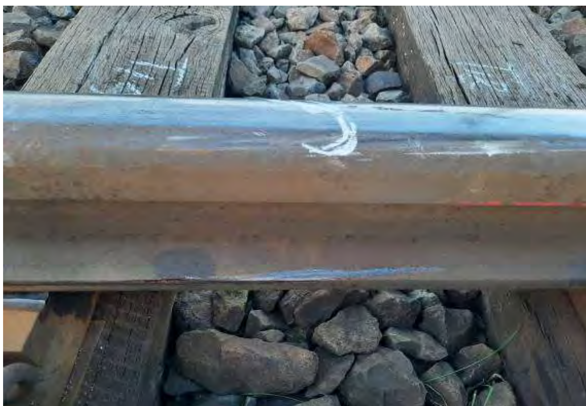
Foto. nr.15– Punctul „C”: urmă de cădere de pe flancul inactiv al suprafeței de rulare a acului curb
