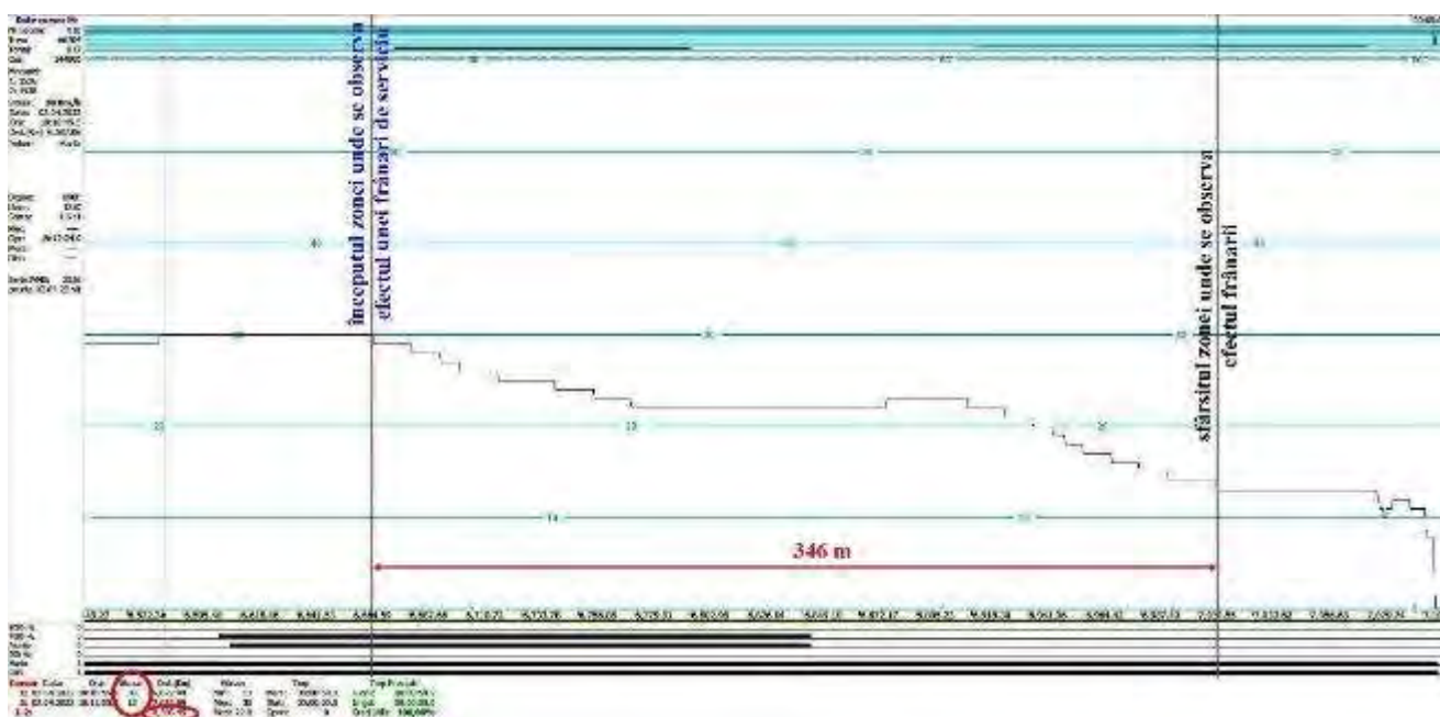
Figura nr.4 – distanța de 346 m pe care viteza trenului scade de la 30 km/h la 13 km/h
