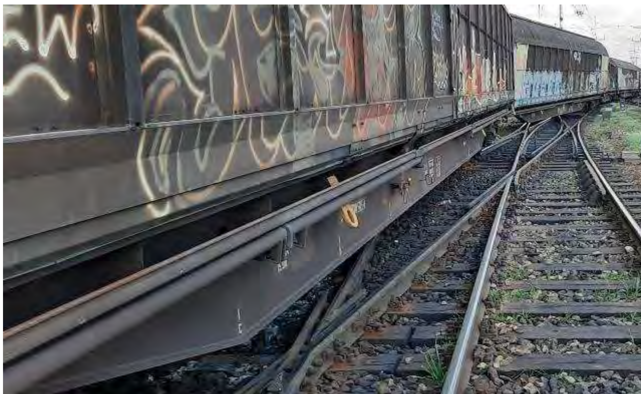
Foto nr.9, vagoanele de marfă deraiate (nr.31842780080-6 și nr.31802780505-6)
