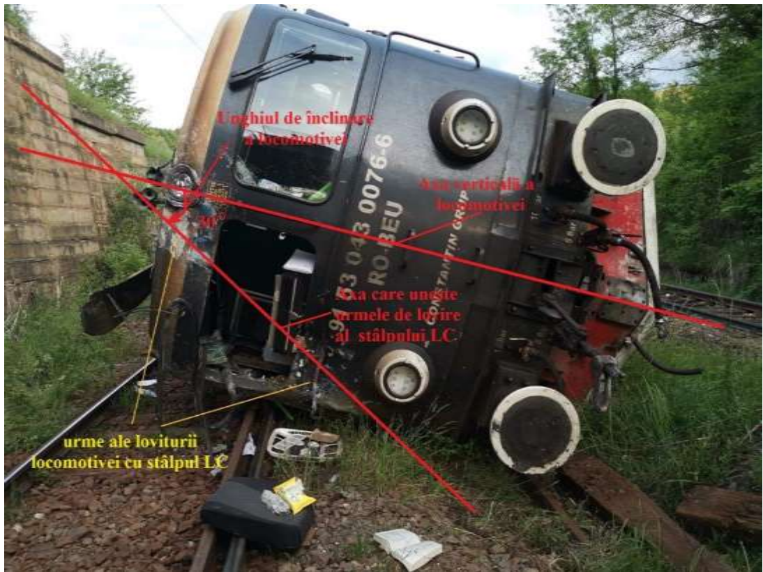
Figura nr.6 – determinarea înclinării locomotivei în momentul lovirii primului stâlp LC
