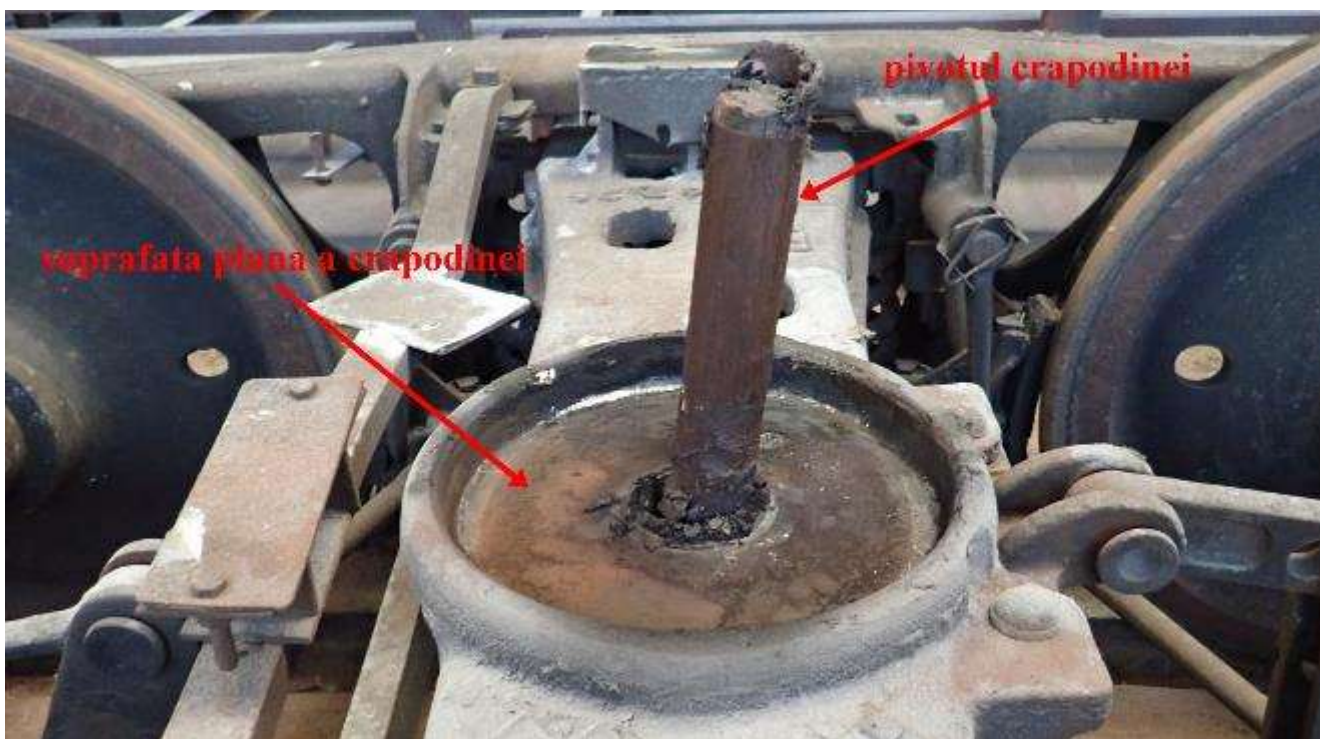
Fig. nr.7, crapodina inferioară de pe traversa dansantă a boghiului
