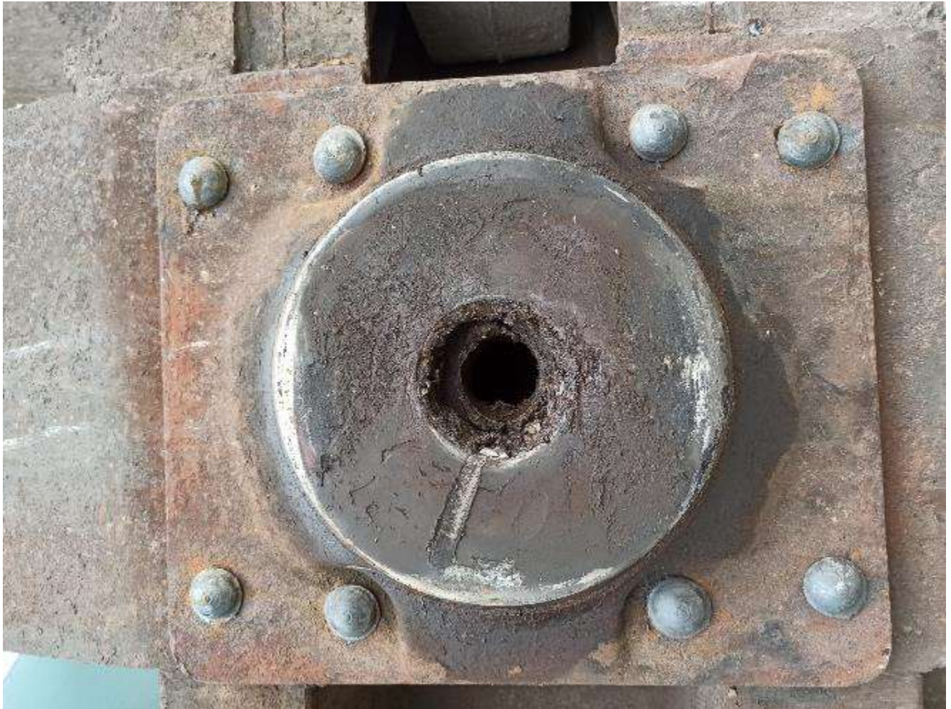
Fig. nr.11, crapodină superioară montată pe cutia vagonului
