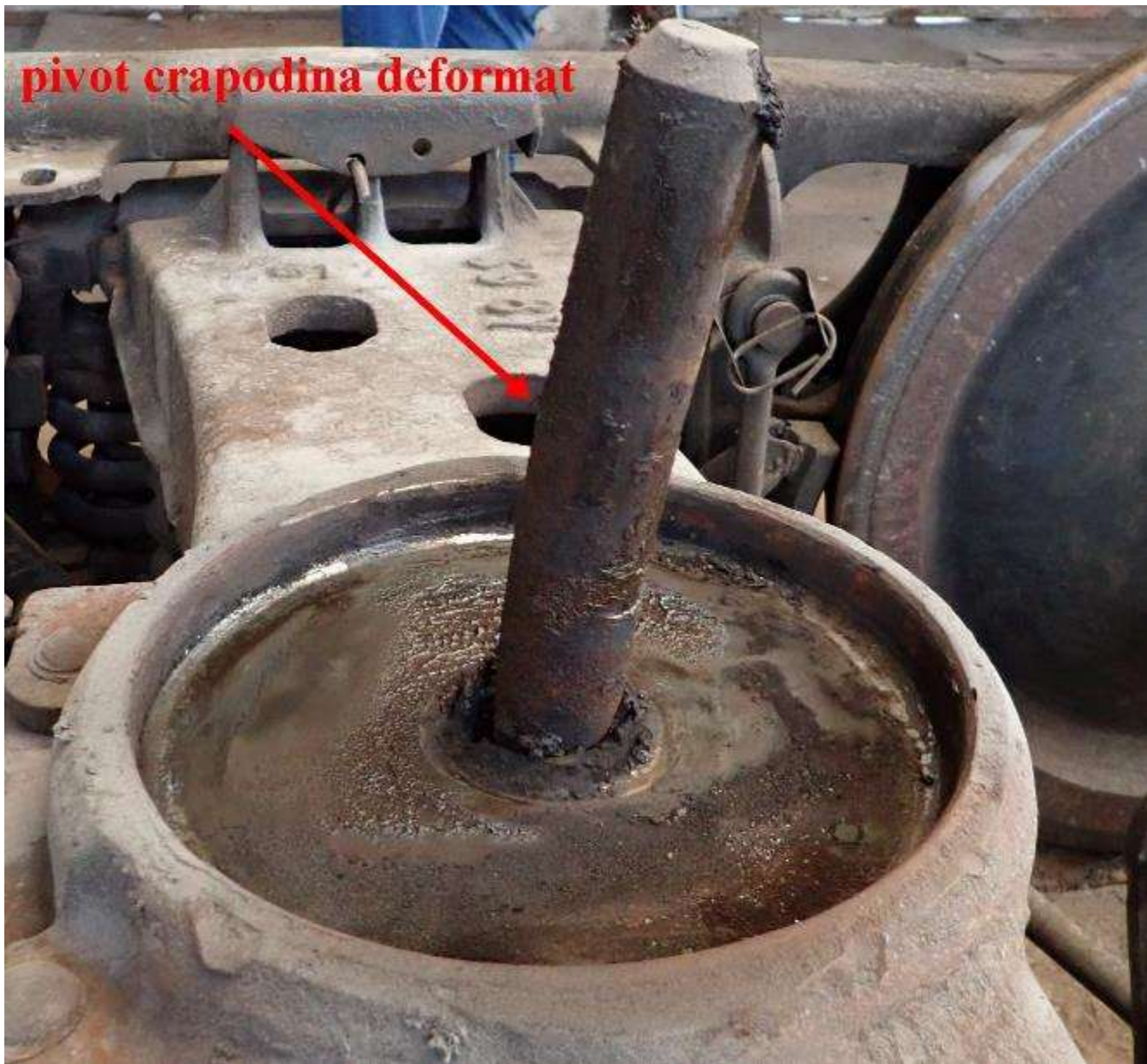
Fig. nr.9, crapodina inferioară cu pivotul deformat
