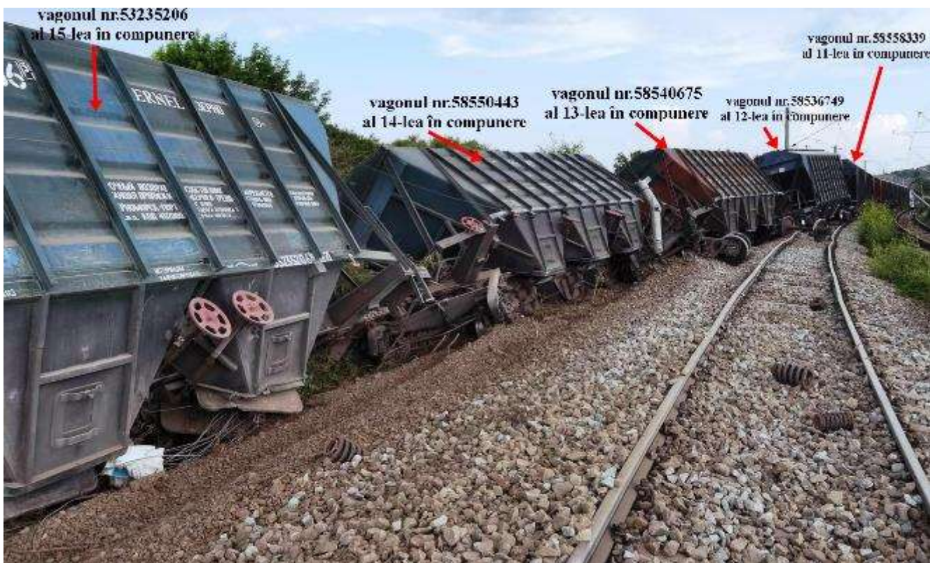
Fig. nr.5, primele 5 vagoane deraiate (de la al 11-lea la al 15-lea)
