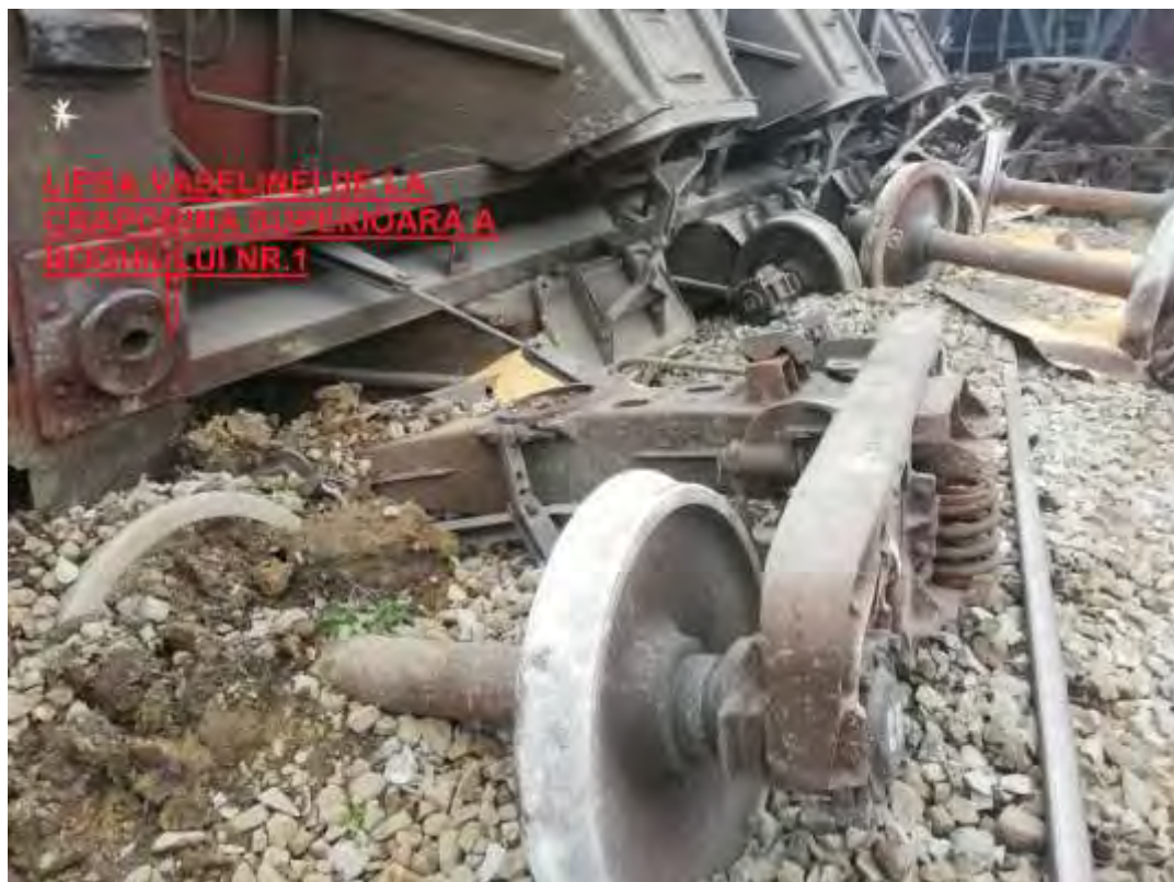
Imaginea nr.4 – crapodina superioară a boghiului nr.1 a vagonului nr.5851311
