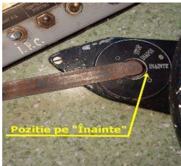
Foto nr.8 Inversor de mers
