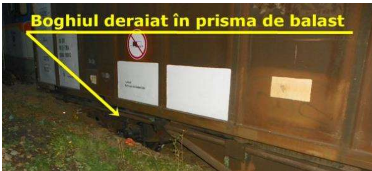
Foto nr.11 Vagonul deraiat de primul boghiu în prisma de balast
