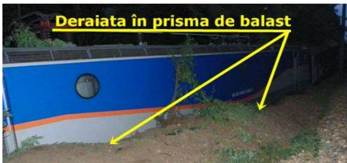
Foto nr.10 Locomotiva deraiată de toate osiile în prisma de balast
