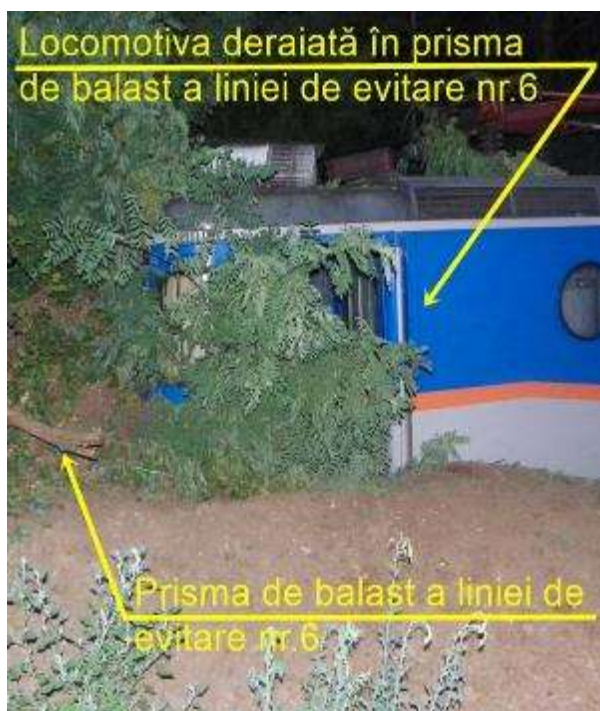
Foto nr.2 Locomotiva electrică EA 090 deraiată în prisma de balast
