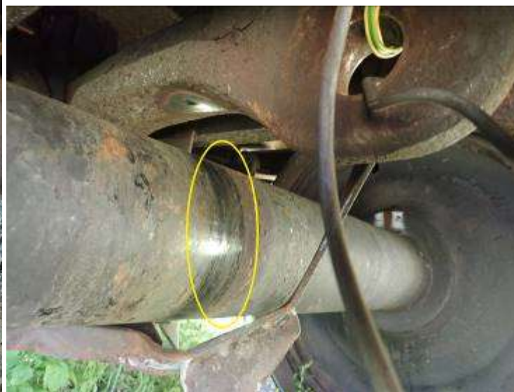
Foto nr.27 – urme de frecare pe osie
