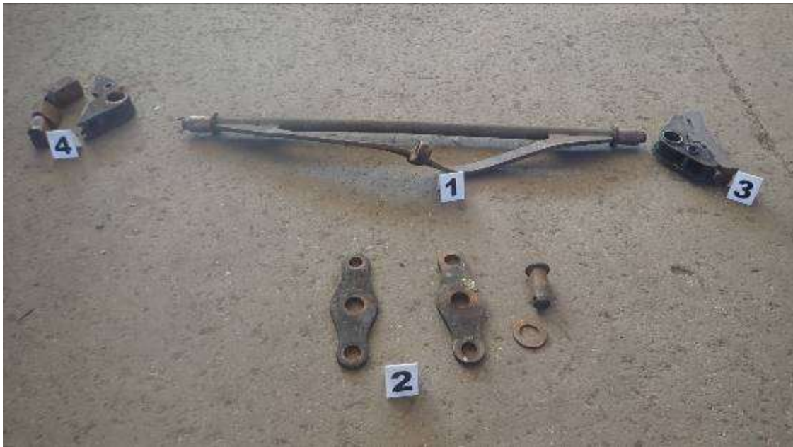
Foto nr.29 – elementele timoneriei de frână găsite la locul producerii incidentului
