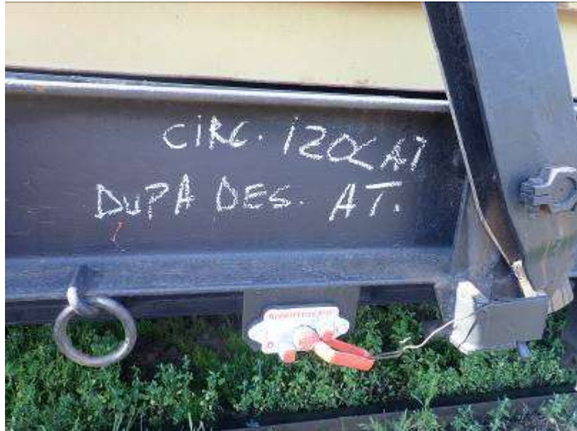
Foto nr.11 – țepușa a fost ridicată în poziția verticală de comisia de investigare
