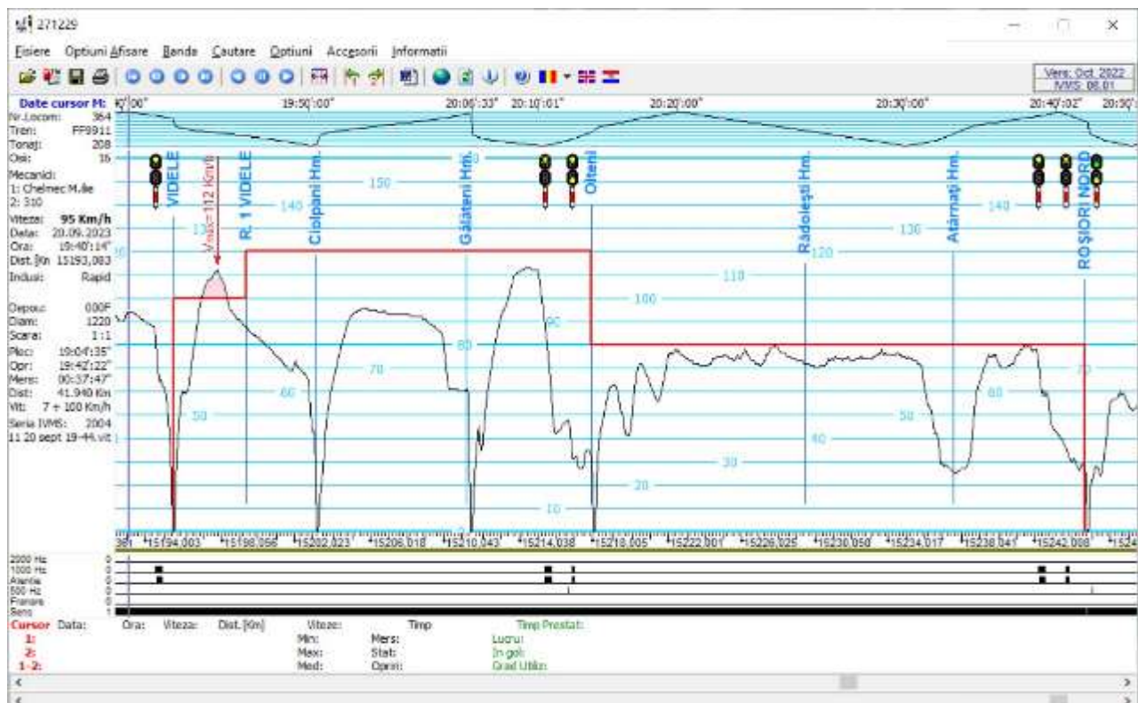
Figura. nr.2 Diagrama înregistrării instalației IVMS, cu depășirea vitezei maxime admise (100 Km/h).
