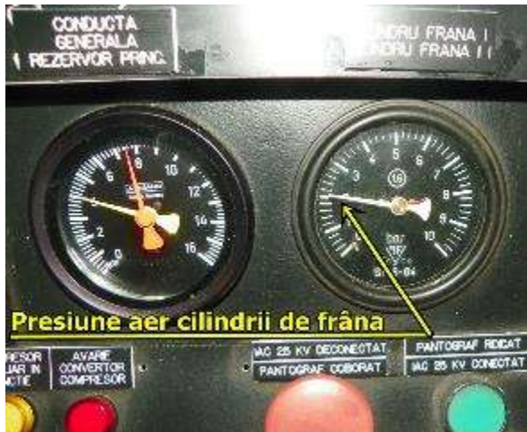
Foto nr.8 Manometre presiuni aer
