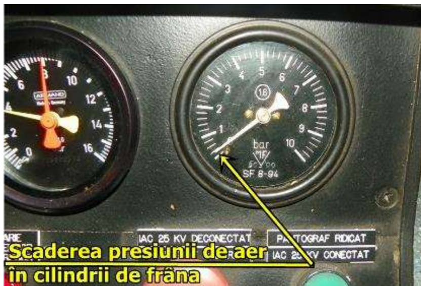
Foto nr.11 Presiunea aerului în cilindrii de frână după manipularea mânerului robinetului frânei directe FD1 de cotiera scaunului
