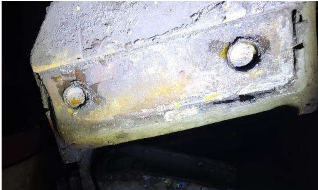
Foto. 7: Șuruburi fixare ale plăcii de gardă aferente osiei nr.1 partea dreaptă retezate
