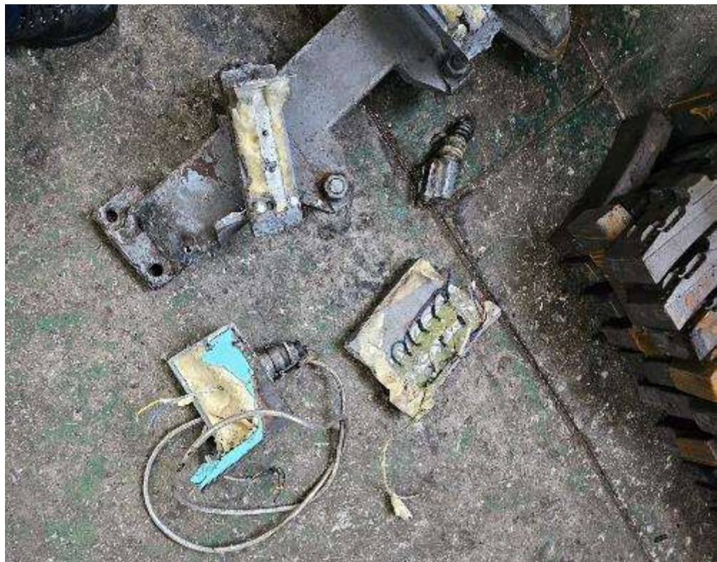
Foto nr. 9: Legătura de gardă, cablu de alimentare smuls al inductorului
