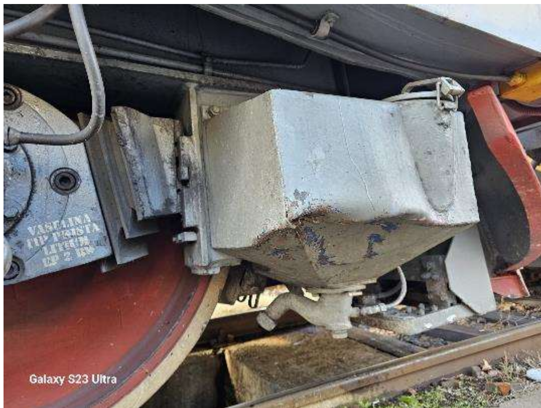
Foto. 2: Osia nr.1 și cutie nisipar deformată
