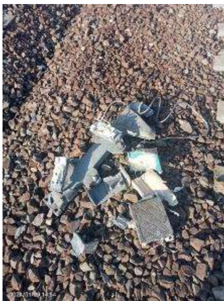
Foto. 5: Piese desprinse de pe locomotiva EA 773
