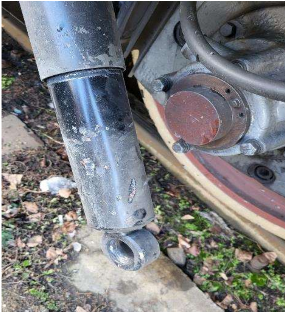
Foto. 6 : Amortizor osia nr.1 desprins
