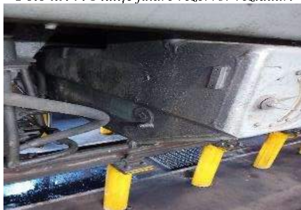
Foto nr. 7: Piulițe fixare rezervor reziduuri
