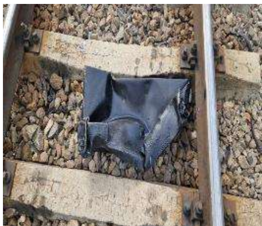
Foto nr.5: Rezervorul colector de reziduuri căzut la Km 47+090
