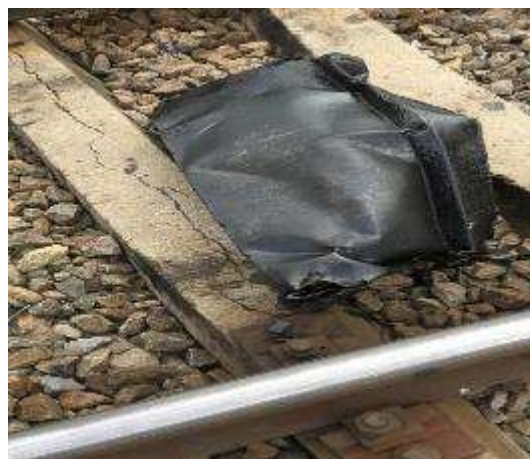
Foto nr.5: Rezervorul colector de reziduuri căzut la Km 47+090
