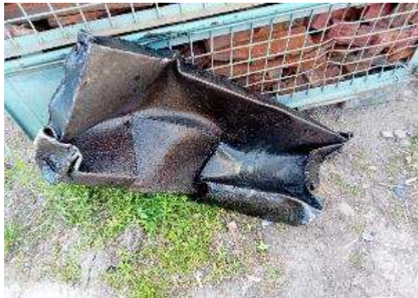
Foto nr. 6: Rezervor reziduuri deformat
