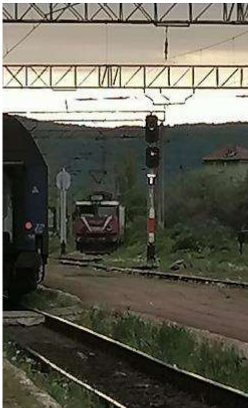
Fotografia nr.3 – Semnalul luminos de ieșire X3 al stației CFR Dej Călători
