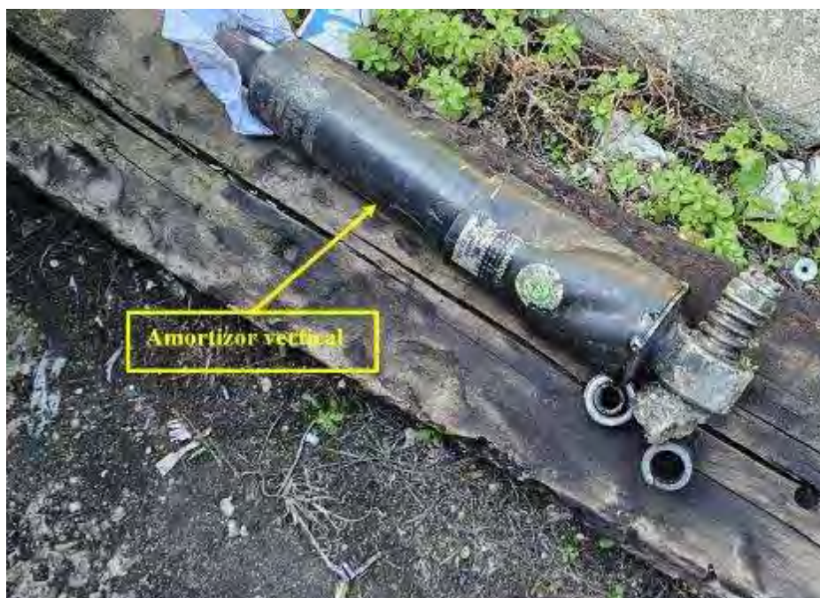
Foto nr.1 Amortizorul vertical al osiei nr.4 locomotiva EA789
