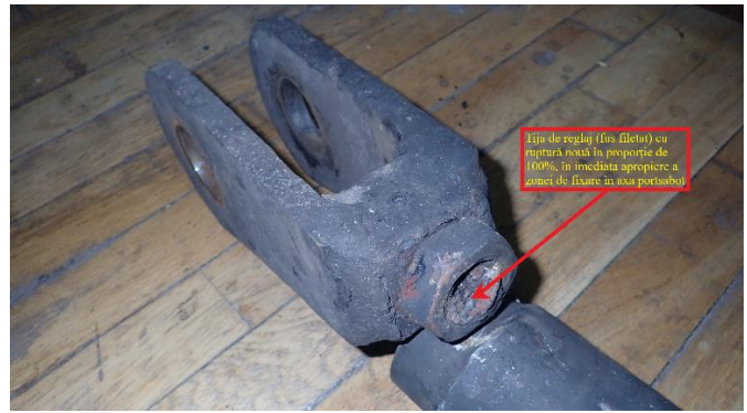
Foto nr.5, Foto nr.6 – Tija de reglaj RL2-350 osia nr.3 cu ruptură nouă în proporție de 100%
