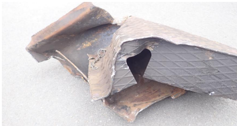
Foto nr.4 - Capacul de protecție DAM al schimbătorului de cale nr.5, deteriorat
