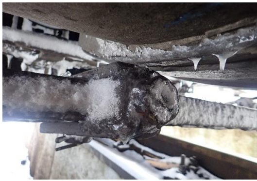
Foto nr.5, Foto nr.6 – Tija de reglaj RL2-350 osia nr.3 cu ruptură nouă în proporție de 100%
