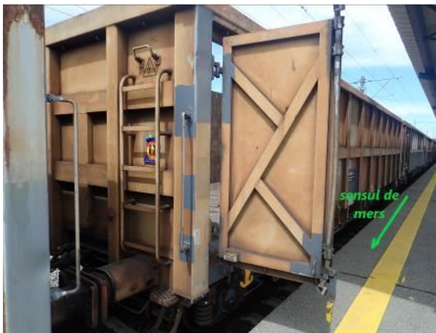
Foto nr.1 – poziția ușii în momentul opririi trenului în Hm Valea Lungă
