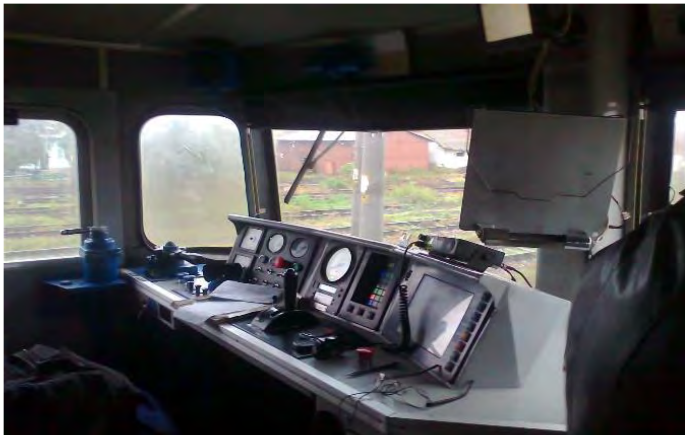
Foto nr.4 – Postul de conducere al locomotivei EA 1004 cu pupitrul de comandă amplasat în partea stângă
